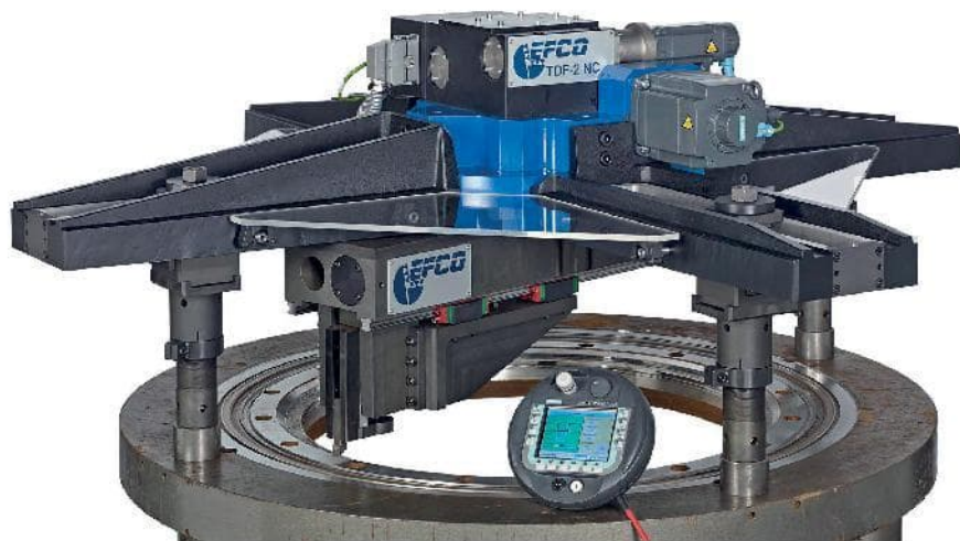
| Закреплённый станок TDF-2NC с панелью управления
