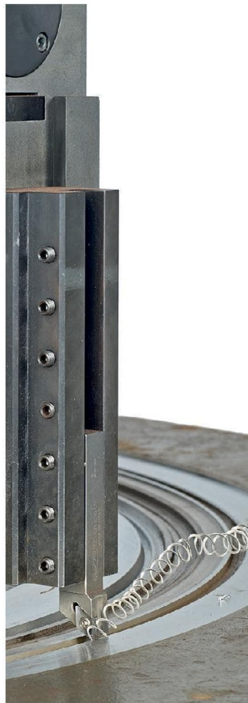
| Обработка канавок на станке TDF-2 NC
