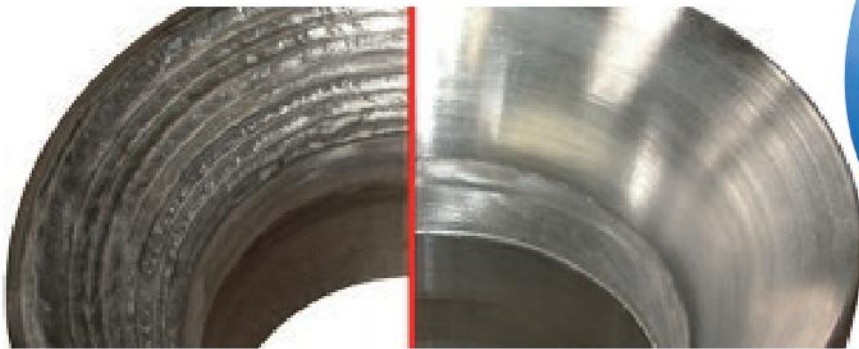
| Результат токарной обработки седла клапана специальной формы
